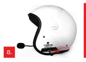
Applicare il tastierino sul lato sinistro (casco indossato), a circa 10 mm dal bordo inferiore della calotta mediante l'utilizzo dell'apposito adesivo fornito. Verificare che ci sia piena superficie di contatto tra il tastierino adesivizzato e la calotta esterna.
