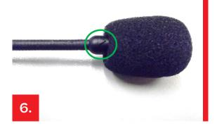
Regolare la posizione del microfono deformando l'asta.
