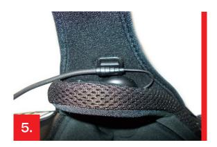
Attaccare il microfono all'interno della patellina tramite il velcro presente sul retro della base microfono.
