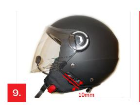
Applicare il tastierino sul lato sinistro (casco indossato), a circa 10 mm dal bordo inferiore della calotta mediante l'utilizzo dell'apposito adesivo fornito verificandone la corretta adesione.
