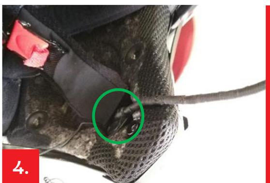
Posizionare la base del microfono sotto il cinturino.
