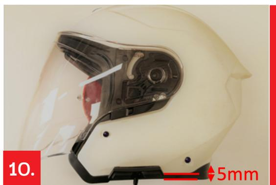
Applicare il tastierino sul lato sinistro (casco indossato), a circa 5 mm dal bordo inferiore della calotta mediante l'utilizzo dell'apposito adesivo fornito. Verificare che non ci sia interferenza con il mentone e che ci sia piena superficie di contatto tra il tastierino adesivizzato e la calotta esterna.
